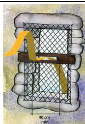
1. Chiroptière dans une ouverture grillagée
