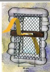
1. Chiroptière dans une ouverture grillagée
