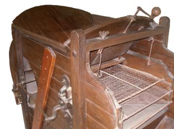
Le tarare est constitué d'un ventilateur activé par une manivelle et des grilles ; ce système sera repris pour la batteuse.
